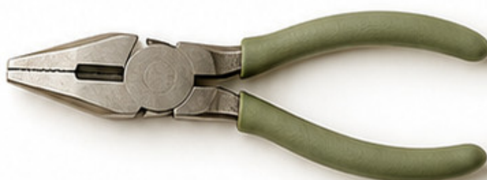
Szczypce płaskie (do zaciskania elementów)
